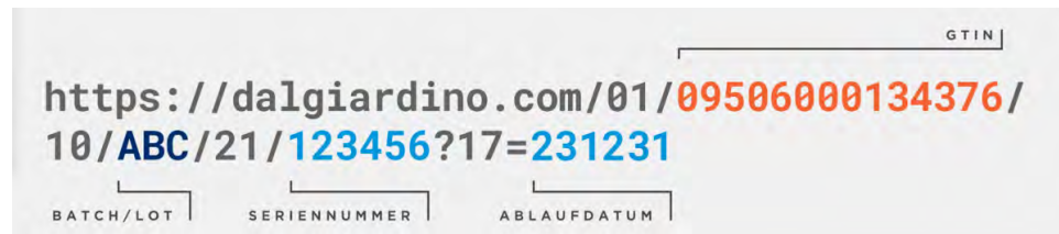
Abb. 4: Beispiel für den Inhalt eines QR-Codes in GS1 Digital Link Syntax
