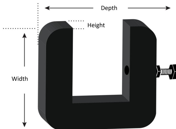
Abmessung mit dem Ende der Schraube bündig zur existierenden Oberfläche
