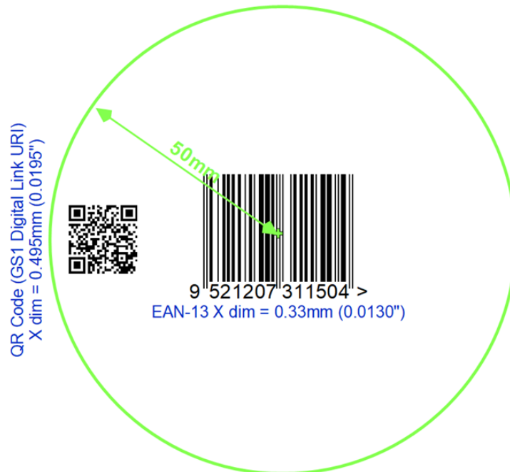
Abbildung 4-3 Platzierung des 2D Codes im Verhältnis zum linearen Barcode
