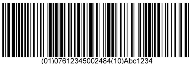
Abbildung 2 - 1: GS1-128 Barcode mit GTIN und Chargennummer
